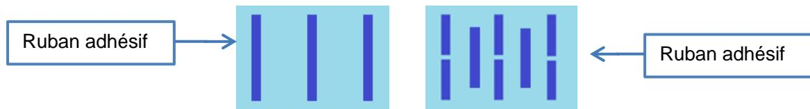
AGC Glass Europe recommande d'utiliser dix bandes de 10 mm x 100 mm par kg de miroir et de les appliquer en plusieurs morceaux plus courts plutôt qu'en une seule longueur (voir ci-dessus).
