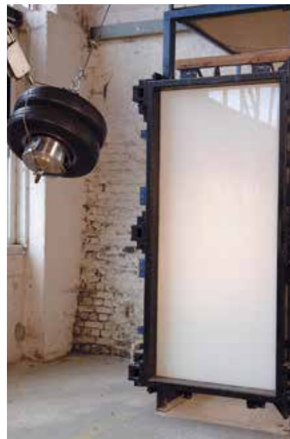
ESSAI D'IMPACT D'UN CORPS MOU
