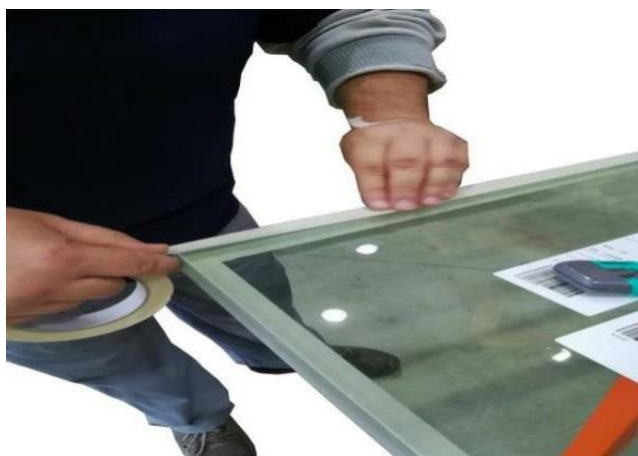
Рисунок 1: Нанесение защитной ленты
