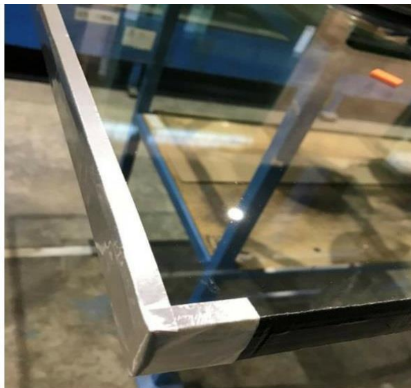
Рисунок 8: Нанесение защитной ленты
