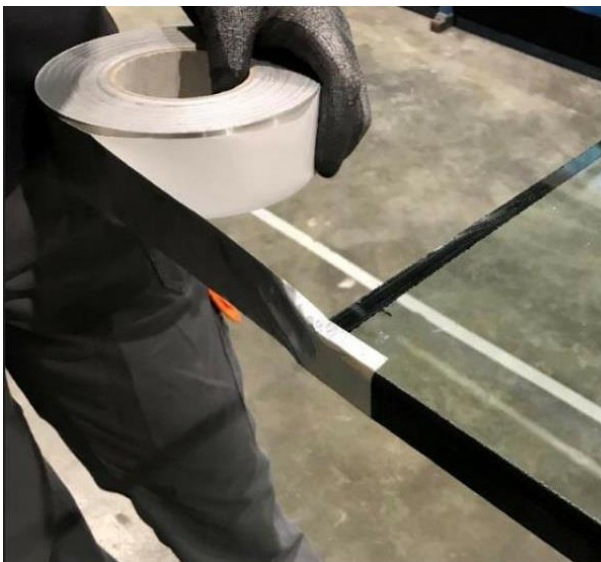
Рисунок 7: Нанесение защитной ленты
