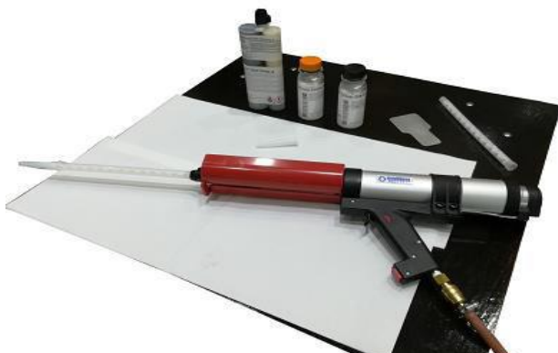
Рисунок 2: Пневматический пистолет с двумя патронами
