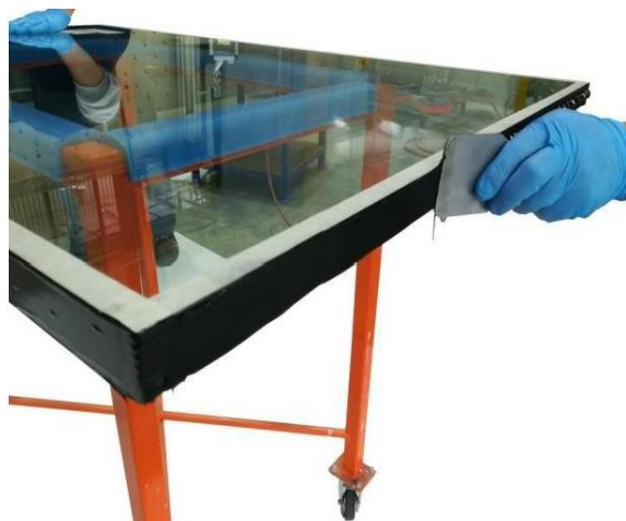
Рисунок 5: Равномерное распределение SikaForce 7550
