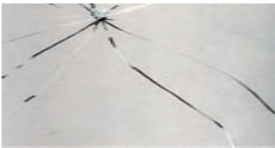
Typowy wzór rozprysku szkła wzmacnianego termicznie
