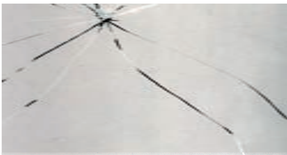
Typický způsob lomu tepelně zpevněného skla
