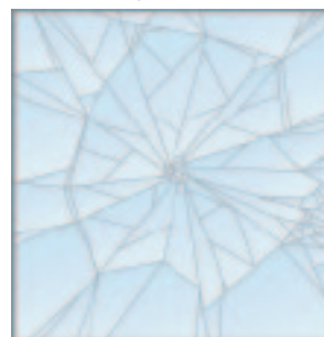
Przykład fragmentacji szkła laminowanego
