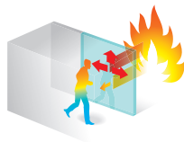
EW (Raumabschluss und Begrenzung des Strahlungsdurchtritts): Begrenzung der Wärmeübertragung auf max. 15 kW/m 2
