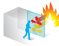
EI (Raumabschluss und Wärmedämmung): Hemmung der Wärmeübertragung
