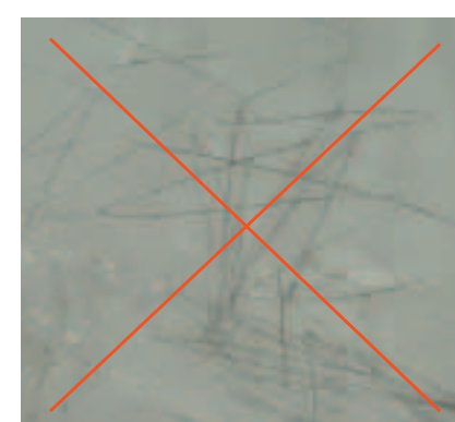
ŹLE: CZYSZCZENIE SUCHĄ I BRUDNĄ SZMATKĄ
