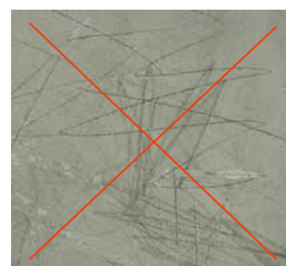
FOUT: REINIGING MET VUILE EN DROGE DOEK
