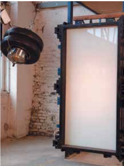
STOOTBELASTINGPROEF MET ZACHT LICHAAM
