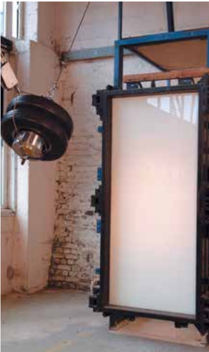
PROVA DI IMPATTO DA CORPO MOLLE
