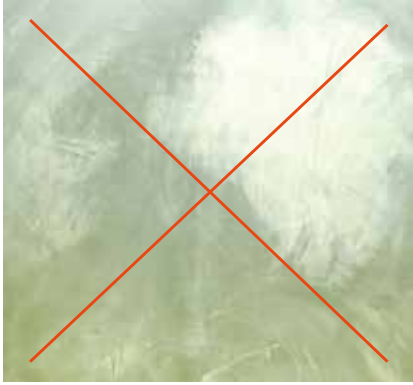
INCORRECT : TACHES SUR LE VERRE
