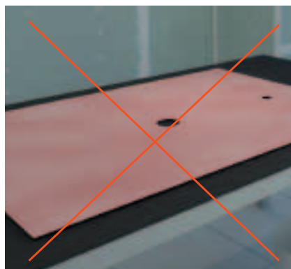
ŠPATNĚ: CHYBÍ POVRCHOVÝ AKTIVÁTOR SILIKONU
