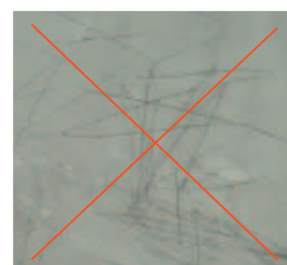
ŠPATNĚ: ČISTĚNO ŠPINAVÝM A SUCHÝM HADŘÍKEM
