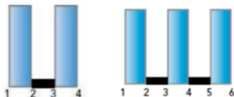
La capa Luxclear no está disponible con un control solar o capa Low-E en la superficie contraria. Por lo tanto, si se requiere un control solar adicional o una capa de baja emisividad, estas capas deben estar en un vidrio separado del vidrio Luxclear.
