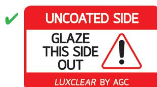
Dado que Luxclear es una capa no conductora y no puede detectarse por medios convencionales, el vidrio debe marcarse con adhesivos (etiquetas) situados en la cara del vidrio sin capa. Los transformadores pueden comprar adhesivos Luxclear en [www.agc-store.com](http://www.agc-store.com).
