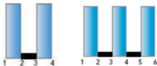
Le revêtement Luxclear n'est pas disponible avec un contrôle solaire ou une couche à basse émissivité sur la surface opposée. Par conséquent, si un contrôle solaire ou un revêtement à faible émissivité supplémentaire est nécessaire, ces revêtements doivent être appliqués sur un verre distinct du verre Luxclear.
