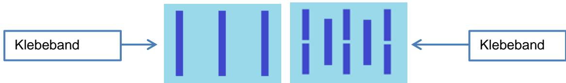
AGC Glass Europe empfiehlt die Verwendung von mindestens zehn Streifen à 10 x 100 mm pro kg Spiegel sowie die Anbringung mehrerer kürzerer Stücke statt eines langen Einzelstreifens (wie oben skizziert).
