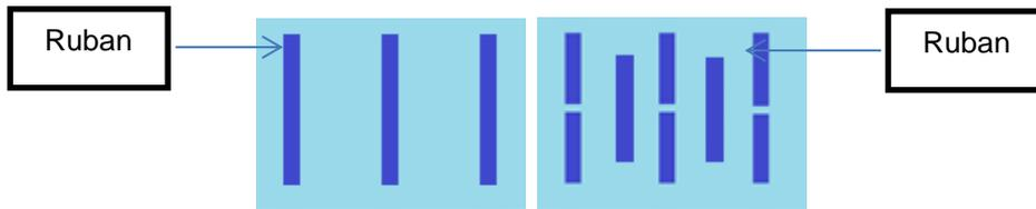
**AGC recommande d'utiliser au moins dix bandes de 10 mm x 100 mm pour 10 kg de verre laqué et d'appliquer plusieurs morceaux plus petits plutôt qu'une seule grande longueur (comme illustré sur le schéma de droite ci-dessus).**
