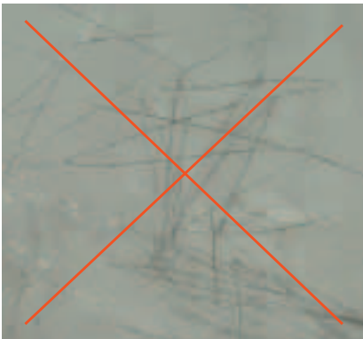
ŹLE: CZYSZCZENIE SUCHĄ I BRUDNĄ SZMATKĄ
