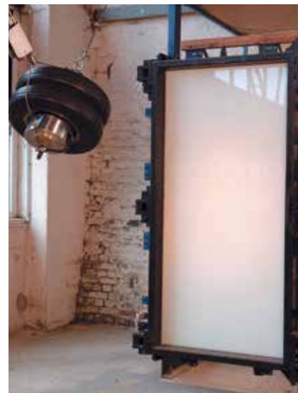
STOOTBELASTINGPROEF MET ZACHT LICHAAM
