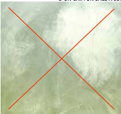
INCORRECT : TACHES SUR LE VERRE
