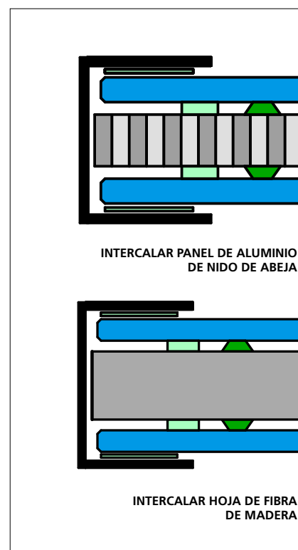
ESTRUCTURAS PARA PUERTA
