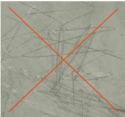
FALSCH: REINIGUNG MIT EINEM SCHMUTZIGEN, TROCKENEN TUCH
