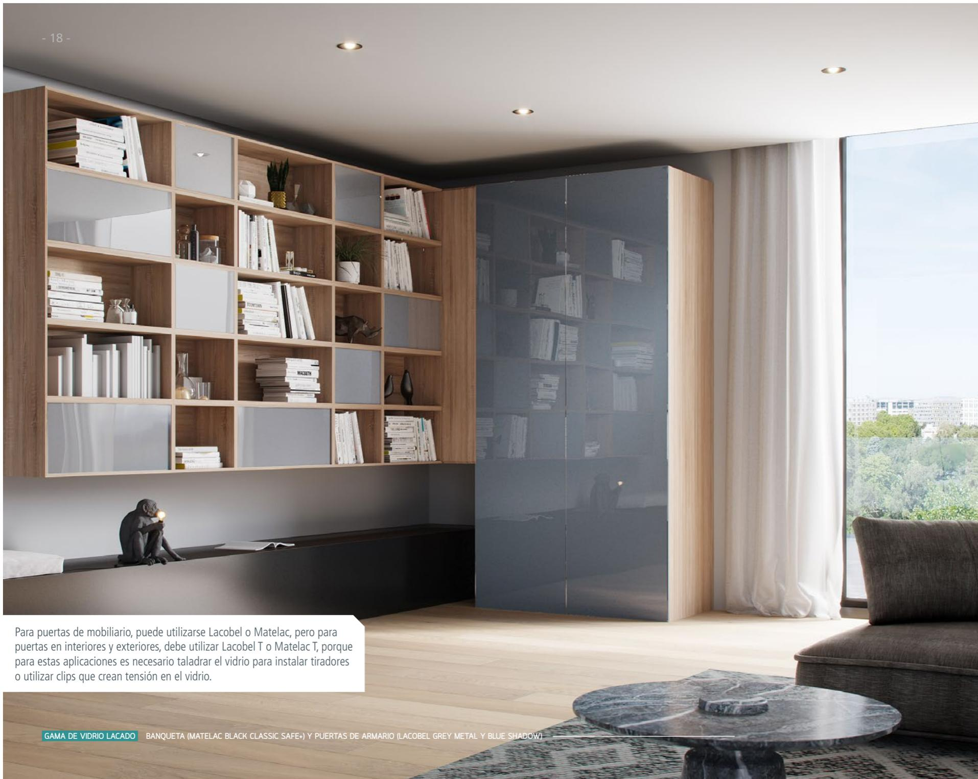
Para puertas de mobiliario, puede utilizarse Lacobel o Matelac, pero para puertas en interiores y exteriores, debe utilizar Lacobel T o Matelac T, porque para estas aplicaciones es necesario taladrar el vidrio para instalar tiradores o utilizar clips que crean tensión en el vidrio.
