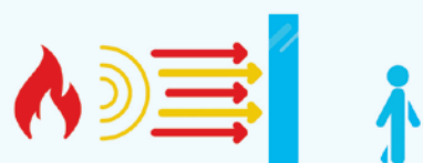
EI – Szczelność i izolacja Żadnych płomieni, dymu, gazów Żadnego przenikania temperatury. Ograniczenia temperatury: Średnia T: maks. 140 °C / punktowa T: maks. 180 °C
