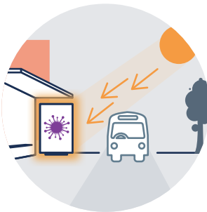
2. Door fotoactivatie vormen zich onzichtbare actieve radicalen op het glazen oppervlak
