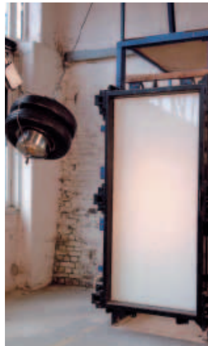
TEST ODOLNOSTI PROTI NÁRAZU MĚKKÝM TĚLESEM
